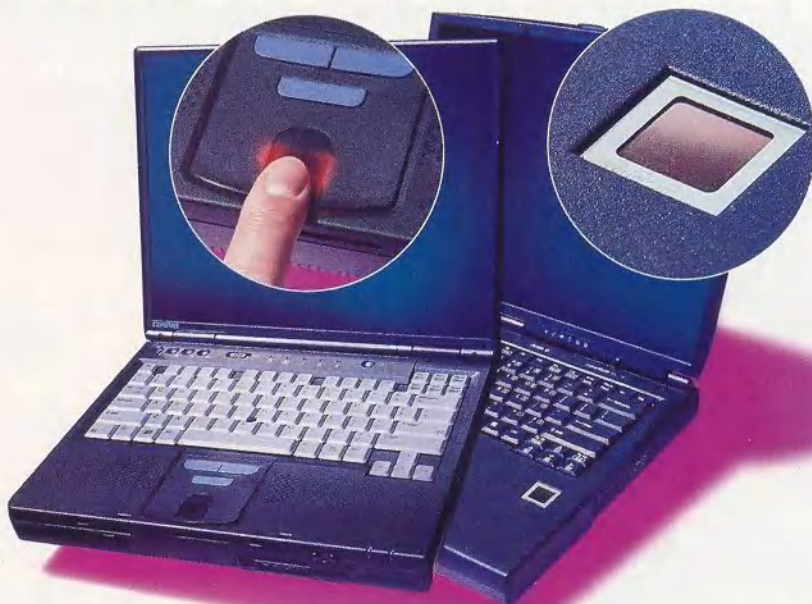
Compaq Armada E500 (слева) и Acer TravelMate 739TLV оснащены встроенными сканерами для идентификации по отпечаткам пальцев
